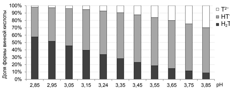
**Рис. 1.** Зависимость распределения форм винной кислоты от pH:  $H_2T$  – недиссоциированная (молекулярная);  $HT^-$  – диссоциированная по первой ступени (битартратная);  $T^{2-}$  – диссоциированная по второй ступени (тарtrатная)
