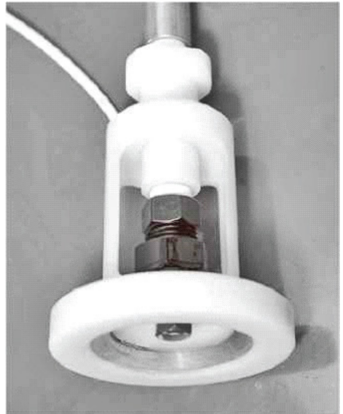
Рис. 1. Форсунка с электрозарядным электродом типа «кольцо» Fig. 1. Nozzle with electrically charged ring-type electrode
